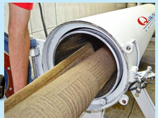
**Centrífuga tubular específica para tapetes**
